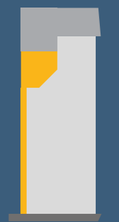
Pose sous linteau
